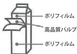
紙パックの表面に貼られたポリフィルムを独自のマルチスクリーン製法できれいに除去することで、高品質の紙パックリサイクルパルプを取り出します。
